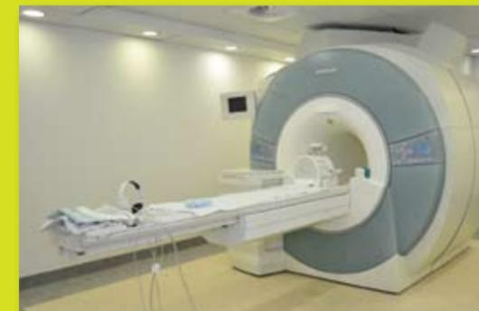
Scanner humain – Appareil d'imagerie par résonance magnétique (IRM) à 3 Tesla Siemens
