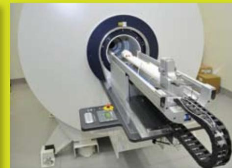
Scanner animal – Appareil d'imagerie par résonance magnétique (IRM) à 7 Tesla Bruker
